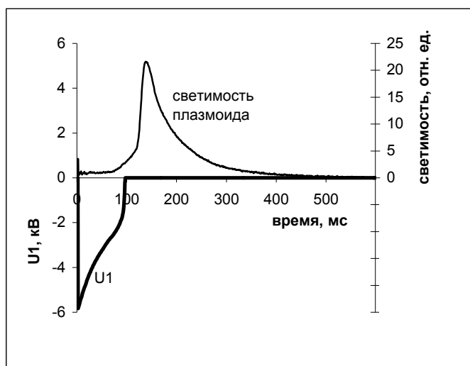
Рис.3. Зависимость светимости летящего плазмоида и напряжения между электродами от времени.
